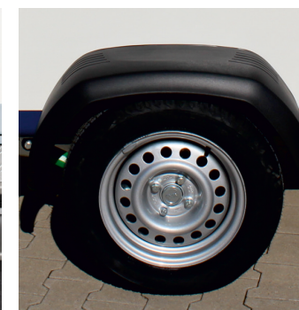
▪ Stahlfelge und Kunststoffkotflügel
