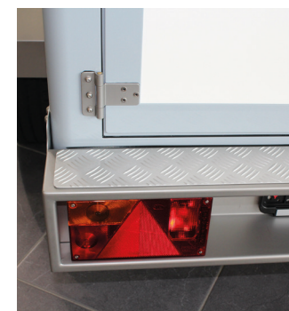
▪ Rücklicht in Edelstahlstoßstange
