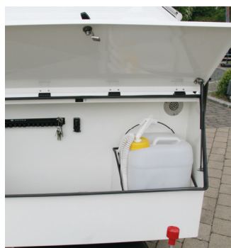
• Staukasten mit Wassertank
